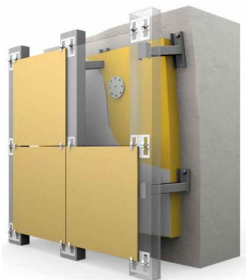
Рисунок 253 – Устройство вентилируемого фасада с облицовкой сайдингом
