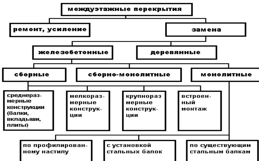
Рисунок 256 – Варианты ремонта или замены междуэтажных перекрытий
